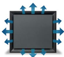
Innovation réduisant l'impact acoustique en diffusant l'air froid à 360° autour de la PAC.
